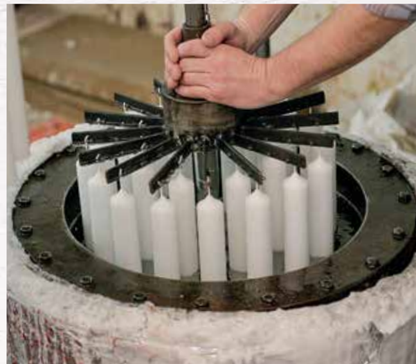
An den Dochten hängen die Kerzen am Tauchkarussell. Im Paraffinbad bekommen sie eine härtere Außenhülle, damit sie beim Abbrennen nicht so schnell auslaufen.
