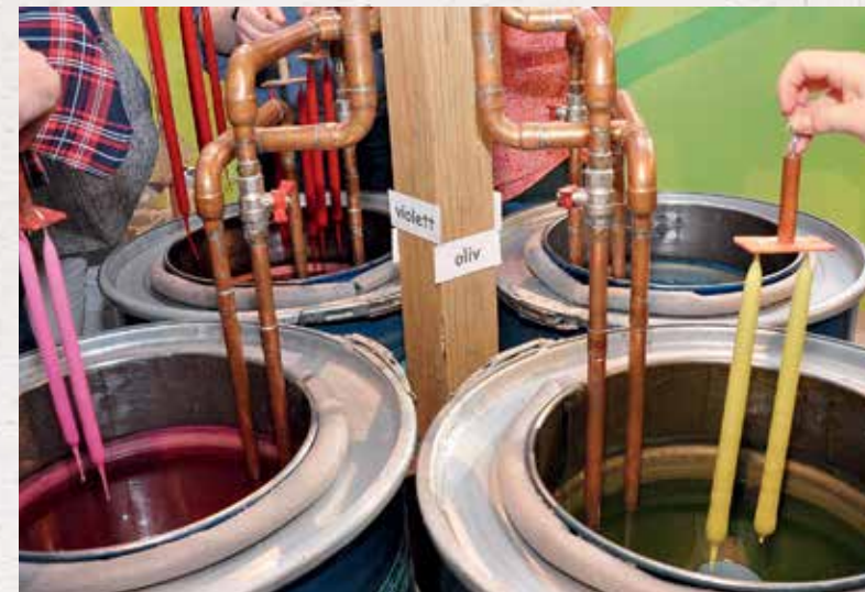
In Kerzenwerkstätten wie „Feuer & Flamme“ in Berlin können Interessierte in rund einer Stunde individuelle Stabkerzen herstellen. Ein Pärchen-Dochtstrang wird immer wieder in flüssiges Wachs eingetaucht, bis die Wunschkerze fertig ist.
