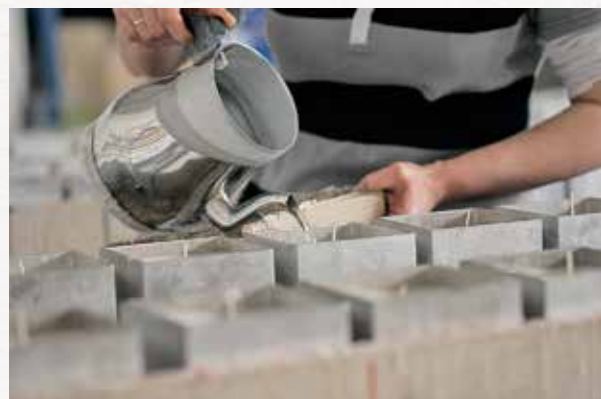
Ein anderes klassisches Verfahren der Kerzenherstellung ist Gießen. Maschinell oder per Hand werden Stumpenkerzen gegossen und Gläser oder Sonderformen befüllt.
